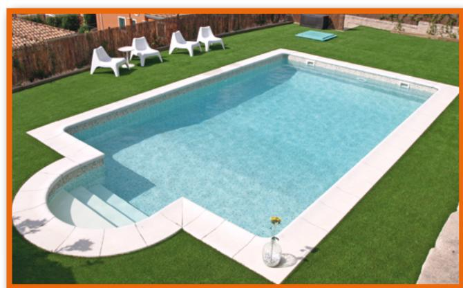
Piscina de acero recubierta con lámina armada Alkorplan 3000 Persia arena
