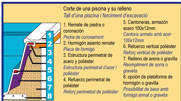
Esquema de instalación de una piscina de poliéster
